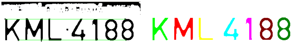
Figura 3. Coordenadas limites horizontais das imagens (à esquerda) e o resultado da segmentação com cada objeto representado por uma cor diferente (à direita).
