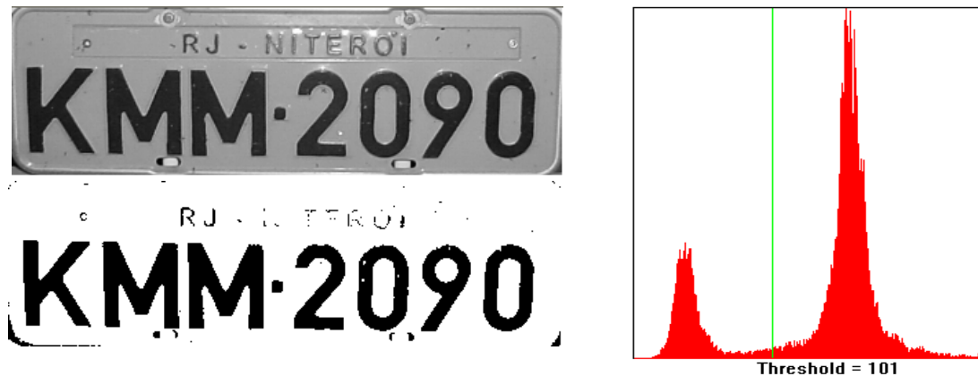
Figura 1. Exemplo de uma imagem inicial a ser analisada nesta etapa, seu histograma (bimodal) à direita com a linha vertical mostrando o ponto de corte usado para a separação entre o fundo e os objetos. Na imagem inferior a direita observa-se o resultado: a imagem bitonal.
