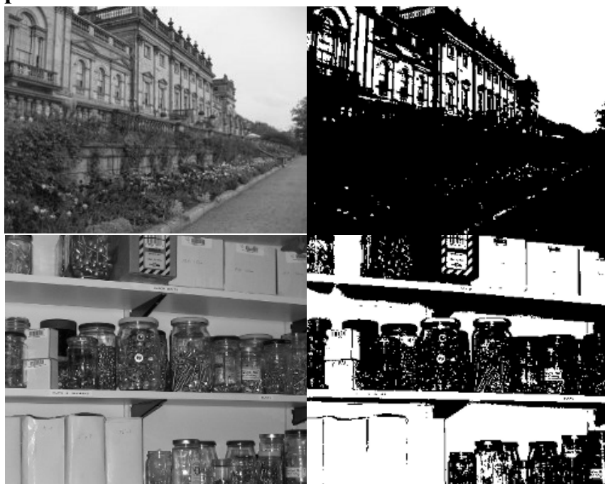
Figura 2. Exemplos de imagens em tons de cinza (esquerda) e seus resultados após a limiarização pelo método de Otsu.
