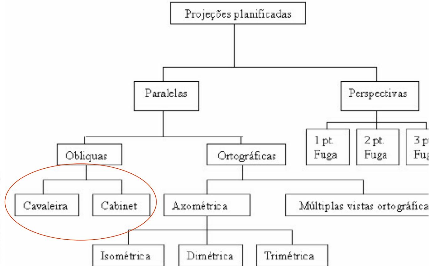
Por definição na **Cabinet** a direção perpendicular ao plano de projeção é **reduzida a metade** . Ou seja os raios projetores devem chegar com um ângulo  $\beta$  cuja **tangente seja  $1/(0,5) = 2$  !** Ou  $\beta = 63,434949^\circ$
