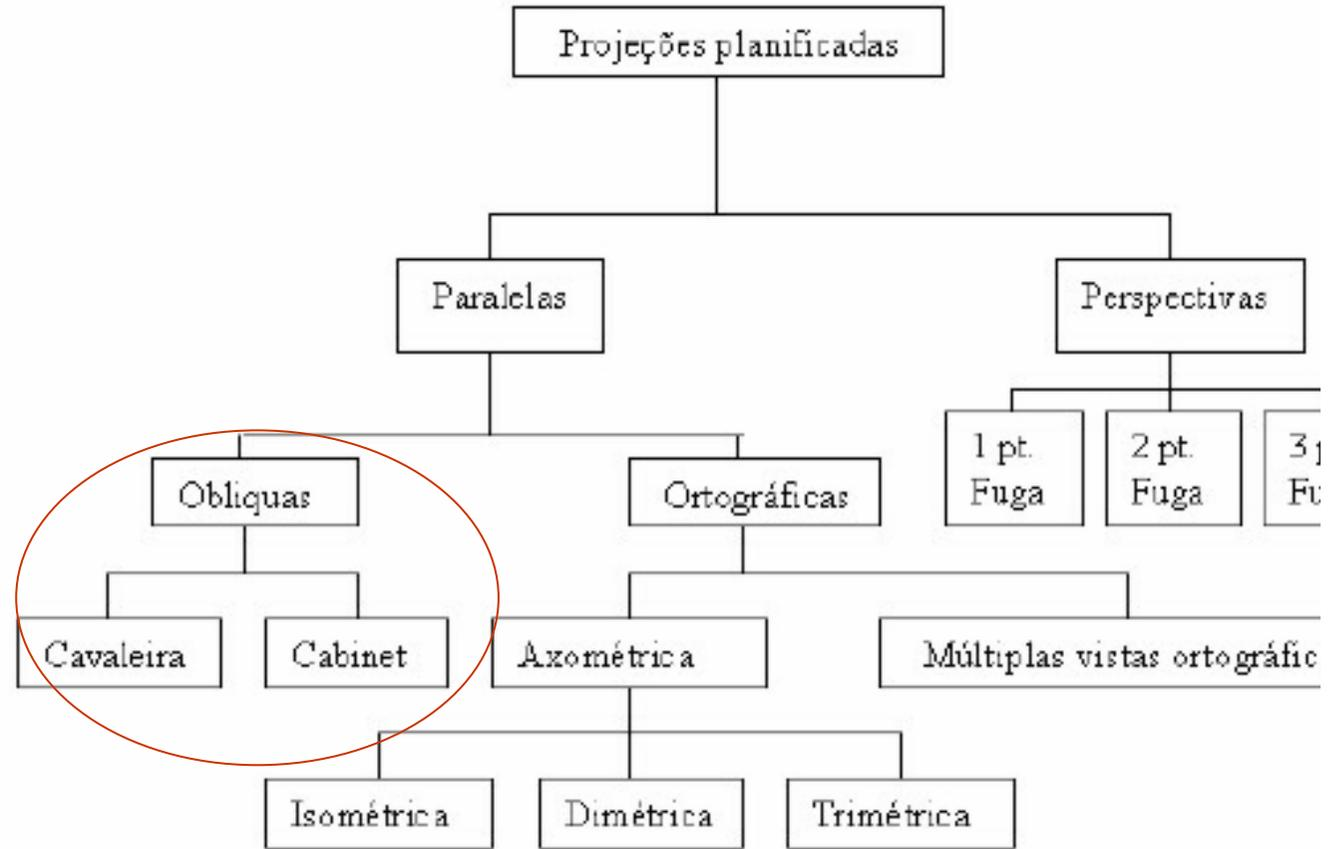
Por definição na **Cavaleira** (cavalier) o eixo com direção perpendicular ao plano de projeção não é alterado. Ou seja os raios projetores devem chegar com um ângulo  $\beta$  de 45 graus no plano de projeção!
