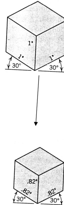
O comprimento na projeção isométrica **muda 82%** !
