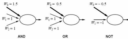
Podemos utilizar as unidades para construir uma rede que calcule qualquer função booleana das entradas.
