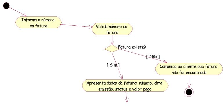
Pontos de decisão: Representam, numa transição, uma condição que é usada para determinar qual caminho, a partir do ponto de decisão, será tomado. Um ponto de decisão é representado através de um losango tendo ao lado a descrição da condição.
