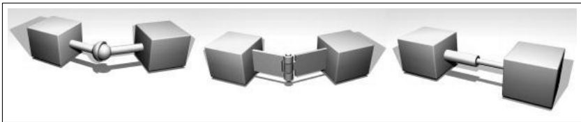
Figura 3.8. Exemplos de junções: esférica, de revolução e cilíndrica
